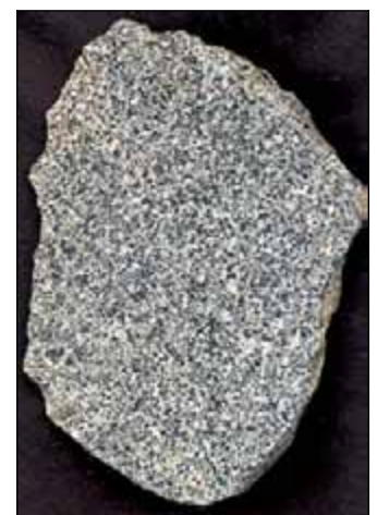
Der Granodiorit ist ein dem Granit ähnliches Tiefengestein aus Feldspat, Quarz und Glimmer. Bild: LGRB
